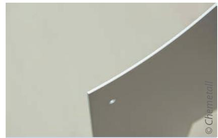
Die silan-basierende Dünnschichtvorbehandlung bietet auch auf Schnittkanten einen exzellenten Korrosionsschutz
