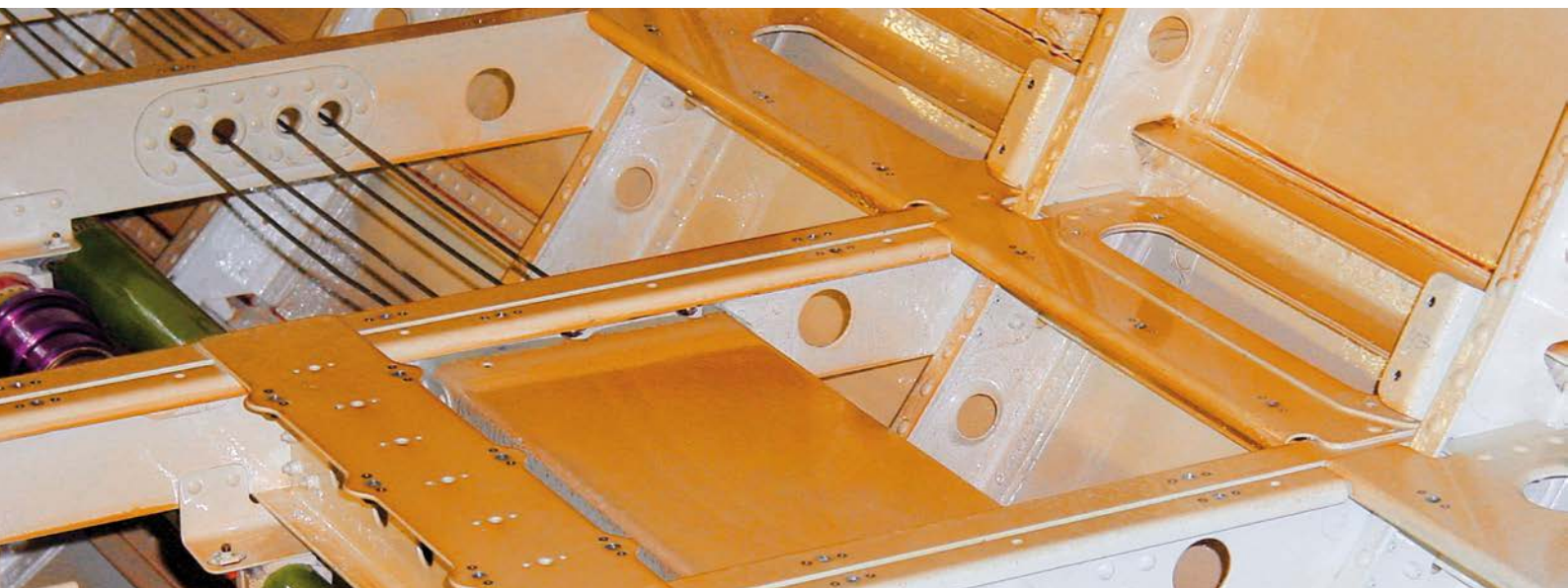
Комплексная защита деталей корпуса самолета с помощью антикоррозионного покрытия Ardrox® AV (CIC)
