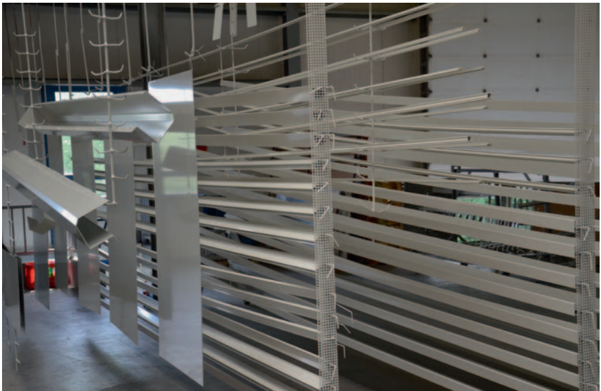
Nach der chrom(VI)-freien Vorbehandlung werden die Aluminiumprofile pulverbeschichtet
