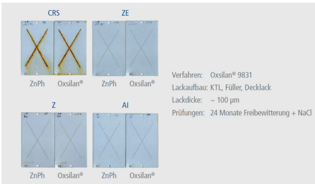
Abb. 1: Vergleichende Bewitterungsversuche mit phosphatierten bzw. mit Oxsilan® 9831 behandelten Musterblechen.
